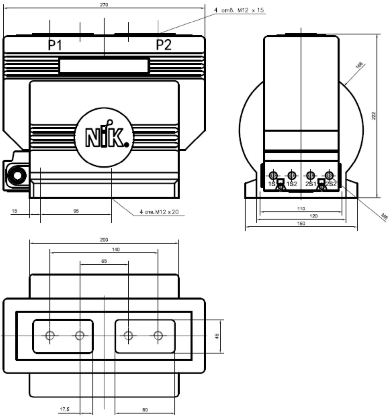
Рисунок А.1 Габаритный чертеж трансформаторов ТОЛН-10...
